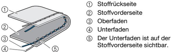
Drehen Sie das Fadenspannungsrad gegen den Uhrzeigersinn, um die Oberfadenspannung zu verringern.
